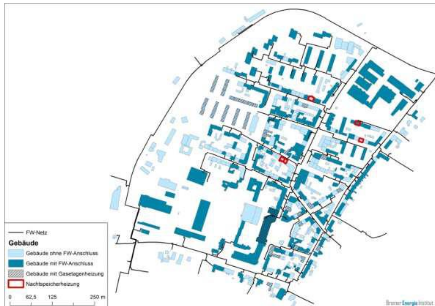
ABBILDUNG 9-22: KARTE MIT DEM FERNWÄRMENETZ IM QUARTIER GAARDEN/KIEL, GEBÄUDE MIT ANSSCHLUSS EINGEFÄRBT (COMPLAN 2013, S.16)
